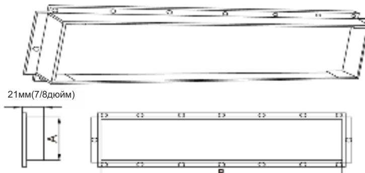
Рис. 4.31 Выход приточного воздуха
