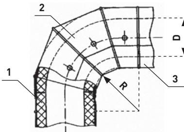
**D** – диаметр изолируемого трубопровода
