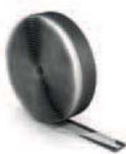
Лента демпферная Energofloor® предназначена для компенсации температурного расширения цементной стяжки в системах отопления типа «тёплый пол». Полиэтиленовая плёнка служит для предотвращения затекания жидкого цементного раствора под нижнюю кромку ленты.
