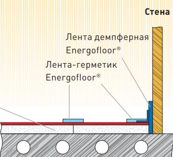
Схема установки тёплого пола
