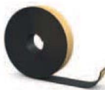
Лента самоклеящаяся Energocell® HT из вспененного каучука обладает низким коэффициентом теплопроводности ( $\lambda_{40}=0,042$  Вт/(м·°C) и предназначена для изоляции фитингов, арматуры и труднодоступных участков трубопроводов в системах отопления, а также для уплотнения различных соединений.
