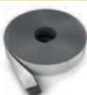
Лента самоклеящаяся Energoflex® Super SK из вспененного полиэтилена обладает низким коэффициентом теплопроводности ( $\lambda_{40}=0,035$  Вт/(м·°C) и предназначена для изоляции фитингов, арматуры и труднодоступных участков трубопроводов в системах отопления и водоснабжения, а также для уплотнения различных соединений.
