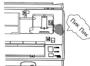
Для выключения кондиционера нажмите на кнопку **EMERGENCY SWITCH**. При этом Вы услышите звуковой сигнал, подтверждающий выключение кондиционера.
