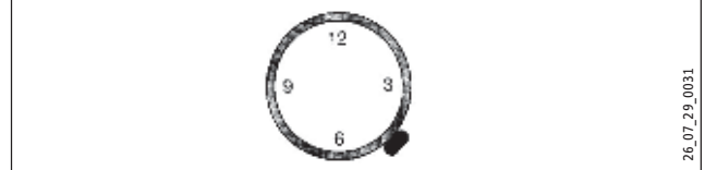
Optimale Position (Rohr im Querschnitt)
