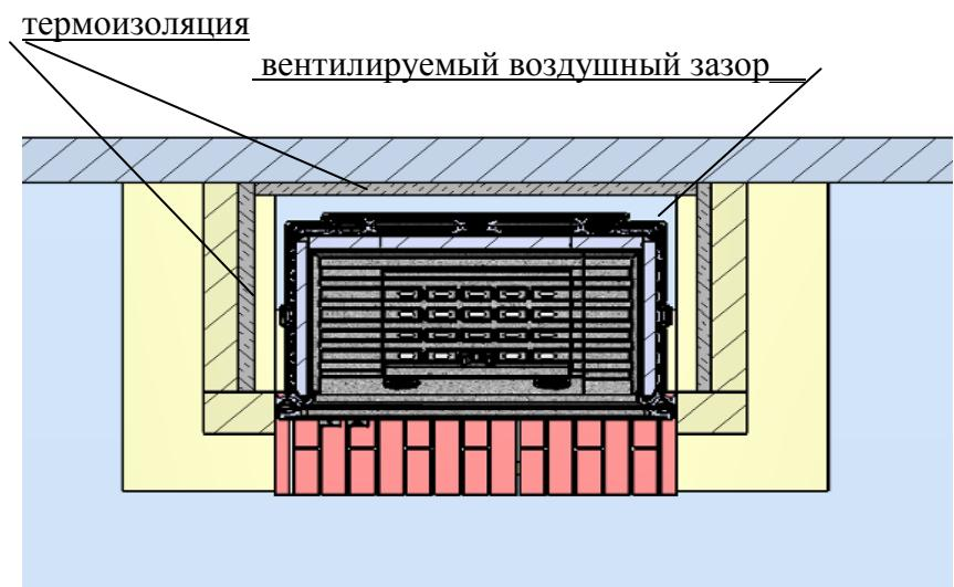
Зашита перегородки из негорючих материалов теплоизоляционным материалом класса A1 или не менее A2 s1 d0.
