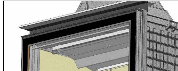
**Механизм регулировки тяговой заслонки: закрытое
