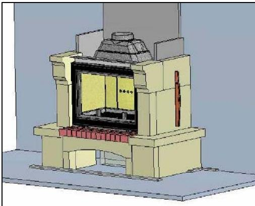
**Типовой пример изоляции опорного основания и стены прилегания топки с помощью минераловатных панелей толщиной 30 мм.**
