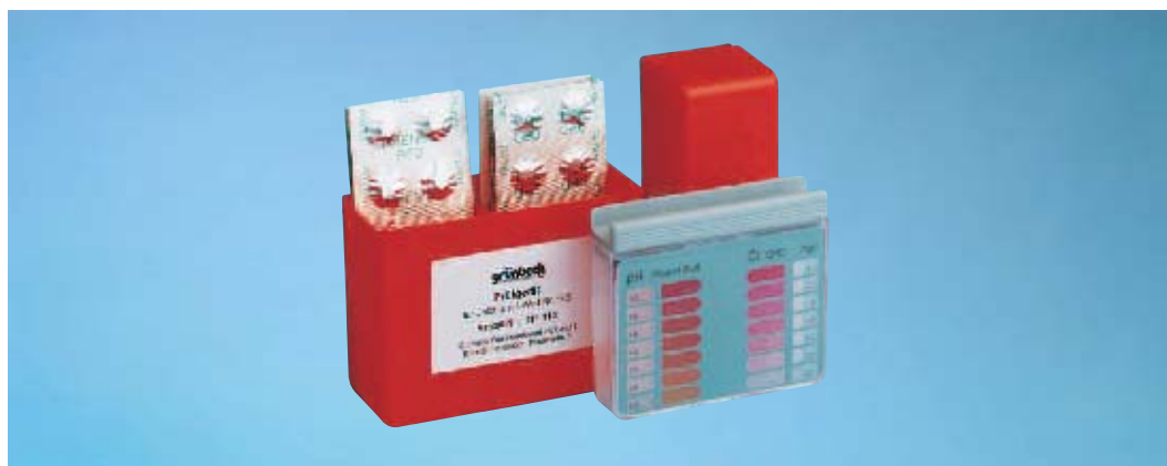
Устройство контроля хлора и значения pH
