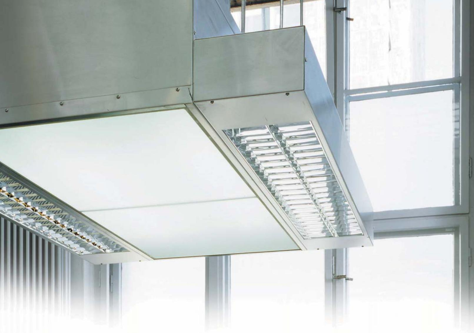
В настоящее время наблюдается тенденция к использованию в системах приточного воздуха диффузоров вытесняющего действия. Ламинарная подача приточного воздуха при большом входном сечении в сочетании с минимальной нижней температурой обеспечивает неощутимое и бесшумное кондиционирование воздуха в помещении. Создаваемая при этом в помещении зона свежего воздуха позволяет лю-
