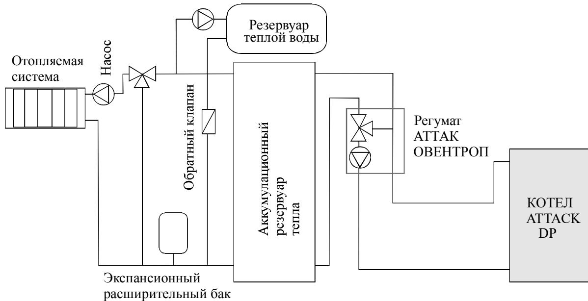
*Котел должен быть постоянно эксплуатирован на номинальной мощности. В случае потребления тепла, когда котел работает на мощности ниже номинального, должно котел присоединить к аккумуляционному резервуару тепла с объемом минимально 460 литров.*
