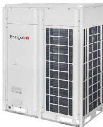
Допускается работа вентиляционной установки в режиме как охлаждения, так и нагрева. Длина трассы от инверторного ККБ до испарителя может достигать 165 м.
