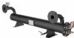
В кожухотрубном теплообменнике применен спиральный тип дефлектора для увеличения теплопередачи без увеличения потерь. Изготовлен из единых труб с внутренним оребрением, обеспечивает высокую надежность во время эксплуатации и снижает требования к качеству охлаждаемой воды.
