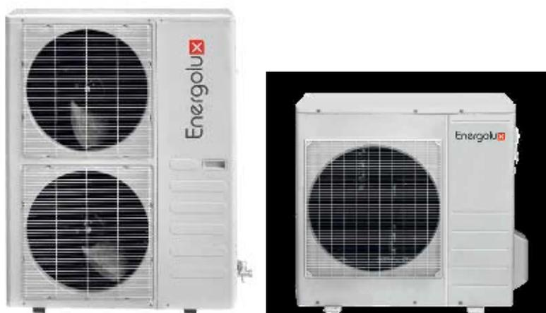
и простом решении. Компрессорно-конденсаторные блоки устанавливаются снаружи здания и подсоединяются к испарителям непосредственного расширения фреоновыми трубопроводами аналогично стандартным сплит системам. Охлаждение воздуха производится в фреоново-воздушных теплообменниках при кипении хладагента. Подготовка жидкого хладагента производится в компрессорно-конденсаторных блоках, в которых установлены элементы холодильного цикла, а так же элементы управления и предохранительные устройства.
