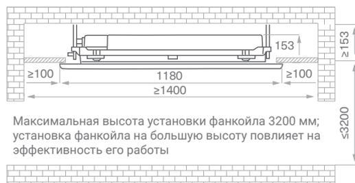
Максимальная высота установки фанкойла 3200 мм; установка фанкойла на большую высоту повлияет на эффективность его работы
