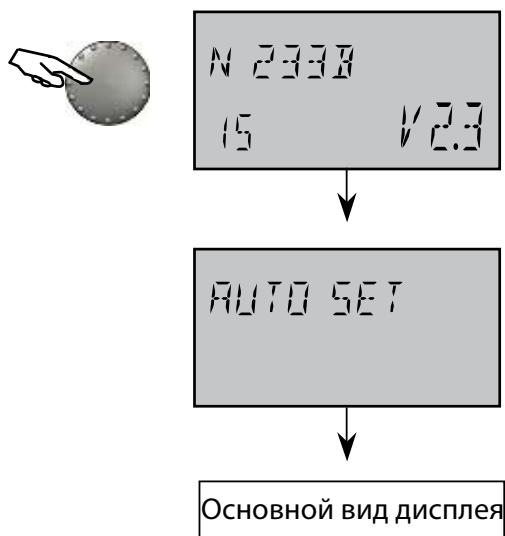
Функция автоматической настройки регистрирует следующие датчики:
