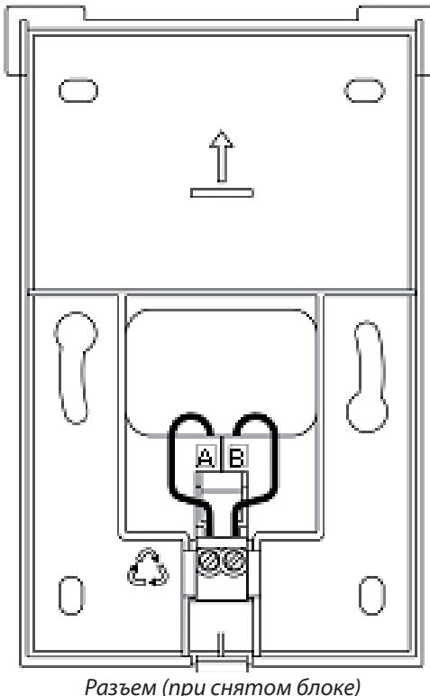
После завершения монтажа электрических соединений заведите верхнюю часть комнатного блока в монтажную коробку и защелкните нижнюю часть.
