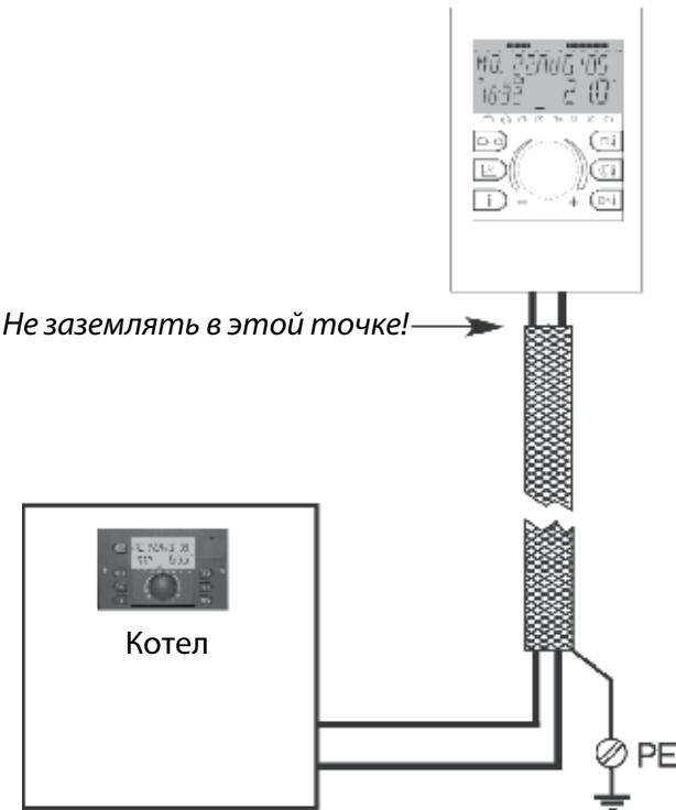
Рис. 4: Заземление экрана в одной точке
