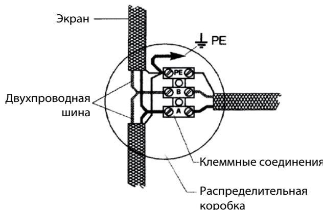
Рис. 5: Заземление в сетях топологии звезды
