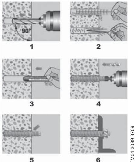
**Рис. 3** Порядок монтажа химического анкера
