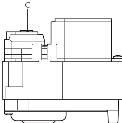
После определения значения давления или его регулировки обязательно запломбируйте регулировочный винт краской или специально предусмотренной для этой цели печатью.
