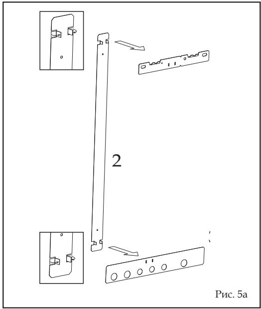
В комплект поставки котла входит планка крепежа к стене "1" с набором дюбелей и винтов, а также разборная металлическая рама (рис. 5а - детали 2 и 3), позволяющая наметить в стене места крепежных отверстий и места подвода к котлу воды и газа.
