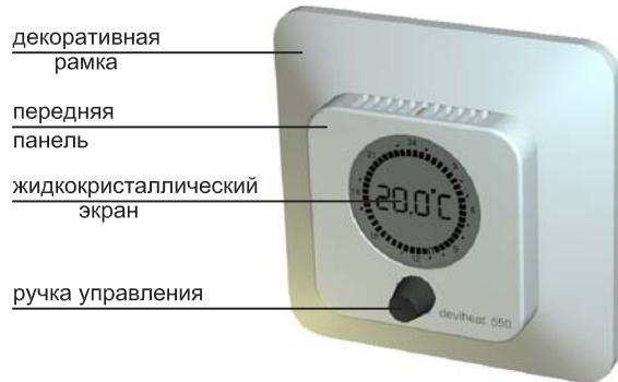
С помощью ручки управления производятся все действия с терморегулятором. На ручку можно нажимать, а можно ручку покрутить против и по часовой стрелке. На экране отображаются цифры и символы, по которым вы сможете определить в каком режиме работы находится терморегулятор.
