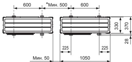
\* При установке одиночного наружного прибора расстояние должно составлять как минимум 15 мм.
