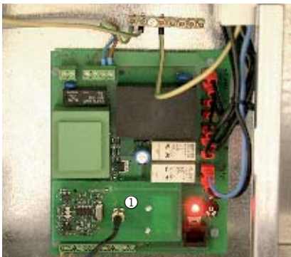
Рис. 3 Винтовое соединение проводов приемной антенны на плате
