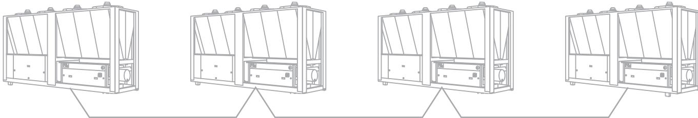
Чиллеры DAIKIN могут быть объединены с помощью контроллеров PCO<sup>2</sup> в единую холодильную станцию DICN (DAIKIN Integrated Cooling Network). Она работает как единый агрегат с суммарной холодопроизводительностью входящих в неё чиллеров, которых может быть не более 4 единиц. В этом случае достигается точное и гибкое управление производительностью, повышающее надёжность холодильной станции.
