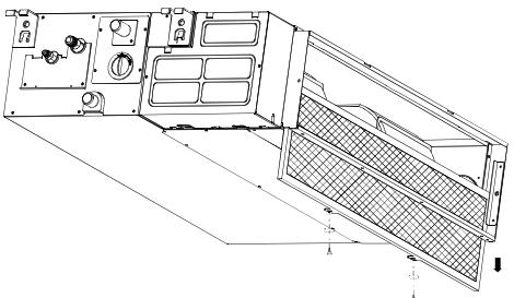
Если забор воздуха блоком осуществляется через нижнюю часть корпуса, слегка надавите фильтр вверх, чтобы освободить его из фиксаторов, и извлеките в направлении, указанном стрелками на схеме ниже.
