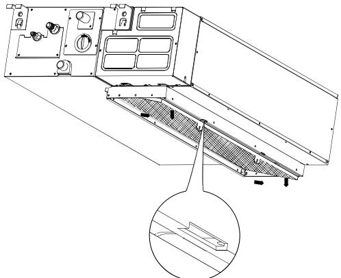
Для чистки фильтра используйте бытовой пылесос или чистую воду. Если пыли собралось слишком много, используйте мягкую щётку и неагрессивное моющее средство. После мытья водой фильтр должен быть высущен без применения источников тепла.
