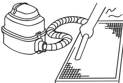
При очистке пылесосом наружная сторона фильтра должна быть вверх, при использовании воды – вниз.
