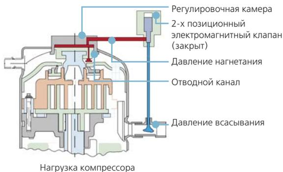
Когда электромагнитный клапан PWM открыт, давление в полости снижается, давление сжатия становится выше, чем давление над диском с неподвижной спиралью и неподвижная спираль перемещается вверх. Полость с высоким давлением соединяется с входом компрессора, и компрессор разгружается.
