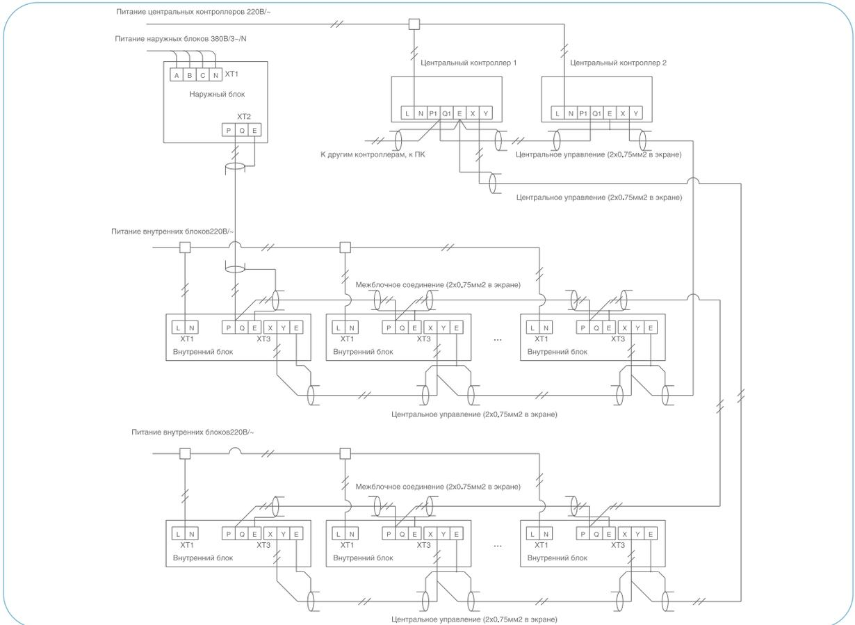
Примечание: разводка цепи центрального управления выполняется при необходимости установки центральных контроллеров ССМ. Максимальное количество подключаемых к одному центральному контроллеру внутренних блоков – 64 штуки. Максимальное количество соединенных в сеть центральных контроллеров ССМ – 16 штук. Минимальное расстояние между силовыми и слаботочными кабелями – 300 мм.
