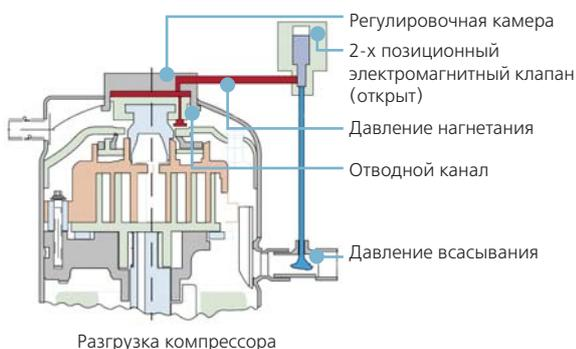
Когда электромагнитный клапан закрыт, диск с неподвижной спиралью опускается вниз, достигается полная герметичность уплотнения спиралей и компрессор нагружается. Изменяя соотношение времени открытия и закрытия клапана, можно регулировать производительность компрессора.
