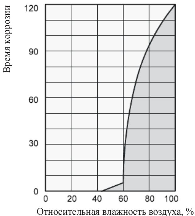
Как видите, скорость коррозии незначительна при относительной влажности воздуха менее 50 %, а при влажности воздуха менее 40 %, скоростью коррозии можно пренебречь. Но когда относительная влажность воздуха превышает 60 %, скорость коррозии значительно увеличивается.
