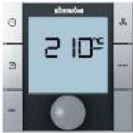
Параметр P36 = 0 «абсолютная» настройка заданной температуры
