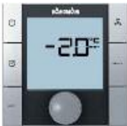
Параметр P36 = 1 настройка заданной температуры ± 3К
