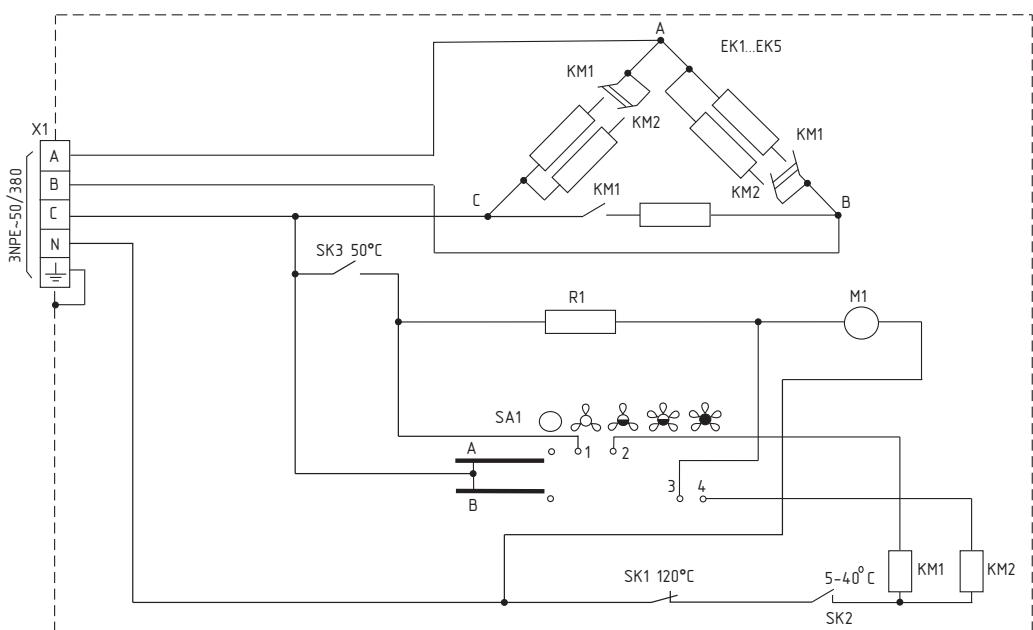
Рисунок 5. Электрическая схема тепловентилятора КЭВ-30Т20Е
