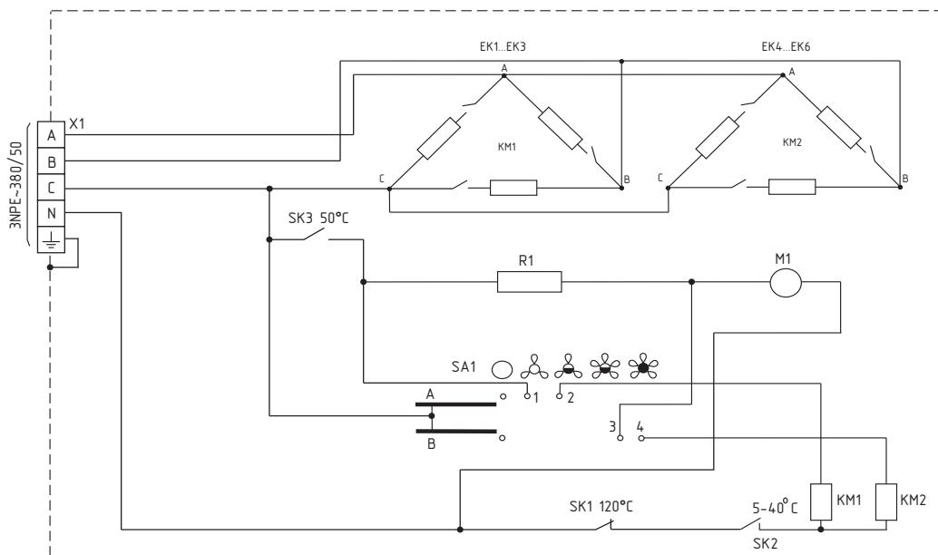
Рисунок 6. Электрическая схема тепловентилятора КЭВ-35Т20Е
