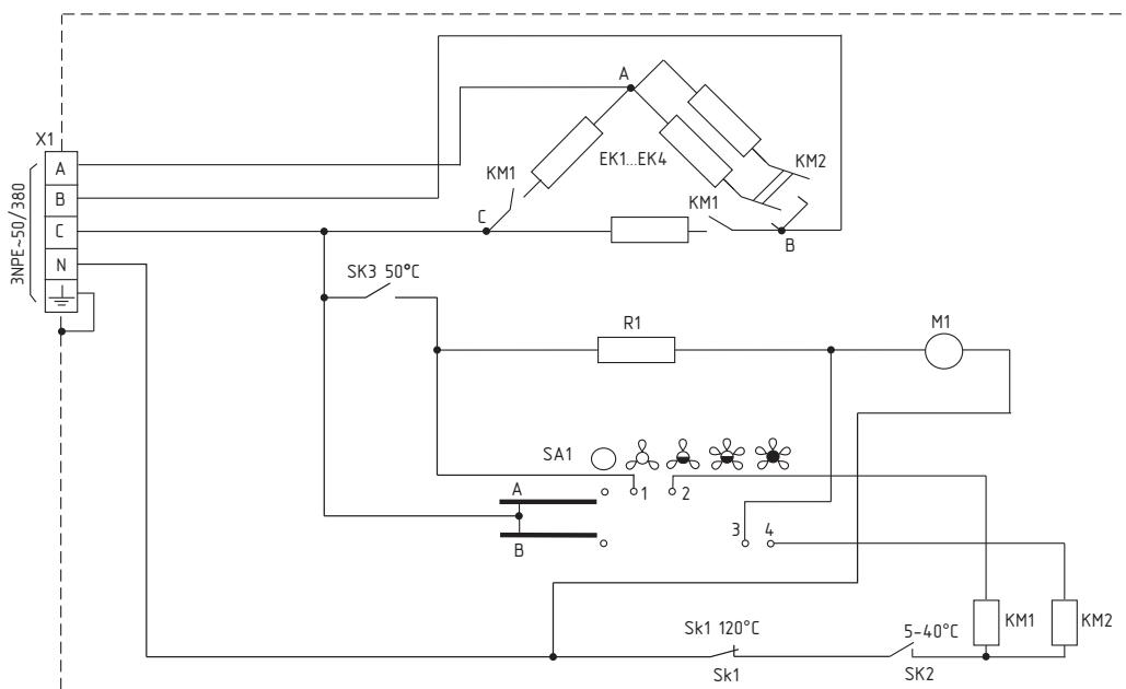
Рисунок 4. Электрическая схема тепловентилятора КЭВ-25Т20Е
