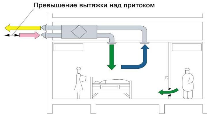
Режим проветривания либо режим предотвращения распространению загрязненного воздуха, возможна работа с датчиками качества воздуха или датчиком CO<sub>2</sub>..
