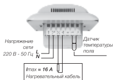
Рисунок 7. Схема подключения терморегулятора к сети
