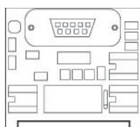
Данная плата позволяет подключить агрегат к сети. Это дает возможность получать оперативную поддержку технического отдела изготовителя или подключить агрегаты к системе централизованного управления оборудованием. Плата подключается к разъему 8.
