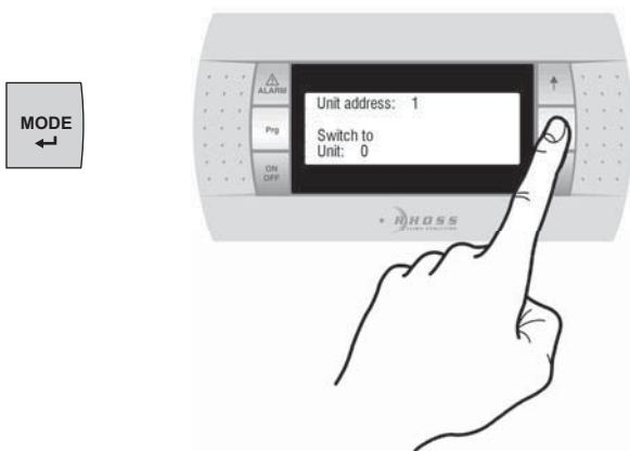
Нажмите кнопку ВВОД, а затем с помощью кнопок ВВЕРХ и ВНИЗ измени-те адрес агрегата.
