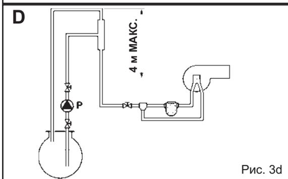
Примечание: для каждого изгиба или запорного вентиля следует добавлять к значению длины трубопровода по 0,25 м (потери напора).
