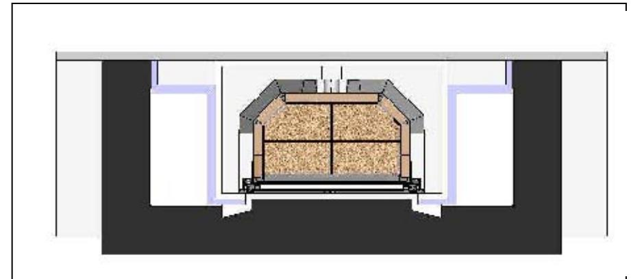
Защита перегородки из негорючих материалов теплоизоляционным материалом класса A1 или не менее A2 s1 d0.
