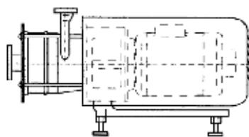
Стационарное крепление на подставке с регулируемыми ножками, двигатель с удлиненным валом и кожухом из нерж. стали.
