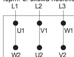
Схема подключения Δ для низких напряжений (Черт. 6)
