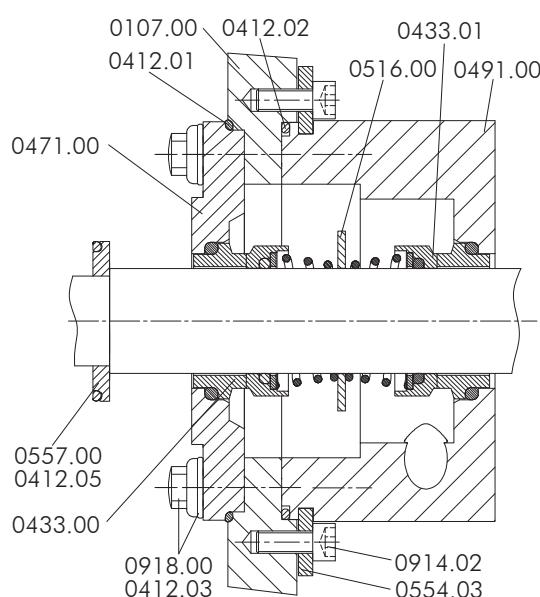
1. Пара уплотнений **0433.00** по стороне продукта и **0433.01** по стороне двигателя собрана в обойме уплотнения **0491.00** и закрыта крышкой **0471.00**.
