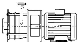
Стационарное крепление на ножках двигателя, двигатель с удлиненным валом из нерж. стали, без кожуха.
