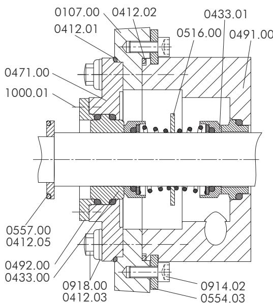
5. Открутить 6-гранные гайки **0920.32** (черт. ) и снять напорную камеру **0107.00** вместе с обоймой **0491.00** и противоходным кольцом уплотнения **0433.01**.
