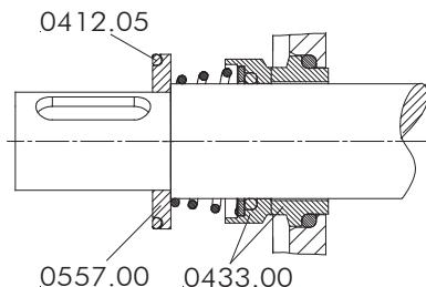
Черт. 29: контактное уплотнение со спиральной пружиной
