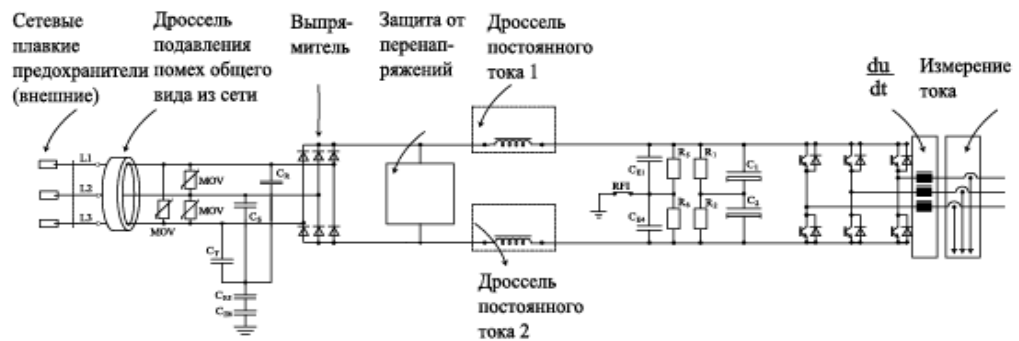
Рис. 4.16. Преобразователи частоты и меры подавления ВЧ-помех
