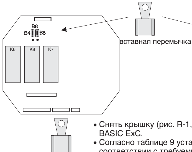
рис. T1: Релейная плата исполнения VX02
