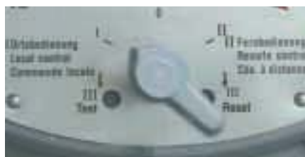
рис. М-3: Ключ-селектор на пульте местного управления
