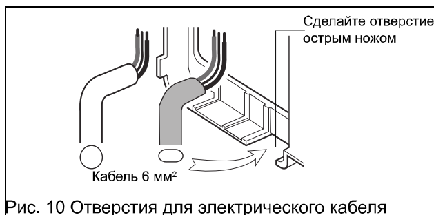
Рис. 10 Отверстия для электрического кабеля
