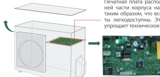
Печатная плата расположена в верхней части корпуса наружного блока таким образом, что все ее компоненты легкодоступны. Это значительно упрощает техническое обслуживание.
