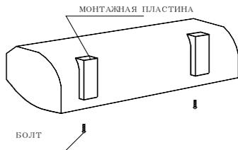
4.1.2 Зафиксируйте крепежные болты. (Определите необходимое положение с помощью монтажной пластины и залейте отверстия под болты цементным раствором).
