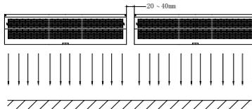
3.5 Не допускайте зазоров между агрегатом и опорой. При потолочном монтаже используйте дополнительное потолочное крепление.
