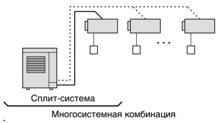
Эта система, работающая в режиме теплового насоса, может работать как на охлаждение, так и на нагрев; она также имеет функцию автоматического выбора режима.
