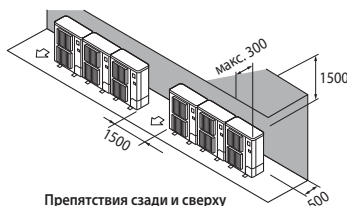
Препятствия сзади и сверху (групповая установка)
