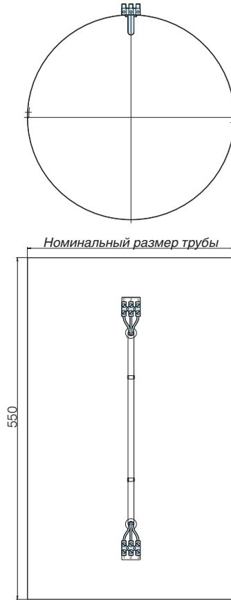
**Электропроводка на диффузоре RRA-V, установленная на заводе**
