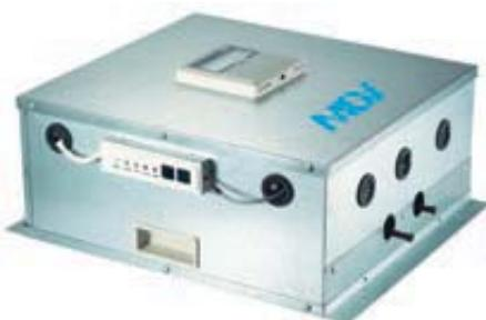
Используются для подключения секций непосредственного охлаждения приточных установок к наружным блокам VRF-систем. Данные комплекты для подключения состоят из шкафа управления, высокоскоростного электронного ТРВ, температурных датчиков и проводного контроллера. Комплекты для подключения приточных установок АНУКZ обладают следующими возможностями управления:
