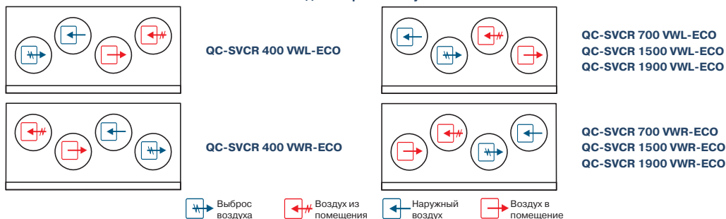
Вид со стороны обслуживания
