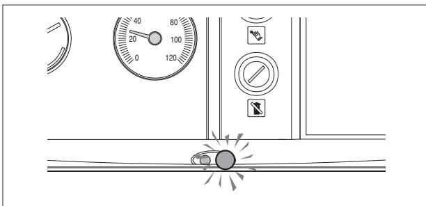
Если сбой повторяется, проверить возможное действие термостата вывода продуктов сжигания, действуя следующим образом:
