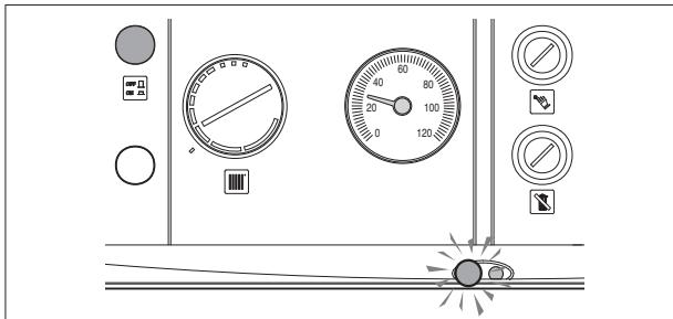
Если при запуске или работе котла произойдёт сбой, котёл перейдёт в режим блокировки, при этом зажигается лампочка красного цвета, расположенная на панели управления.
