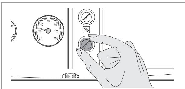
**⚠️** Если термостат вывода продуктов сжигания повторно вступает в действие, проверить, чтобы в выпускном трубопроводе продуктов сгорания не было закупорок, а также правильность его конструкции.
