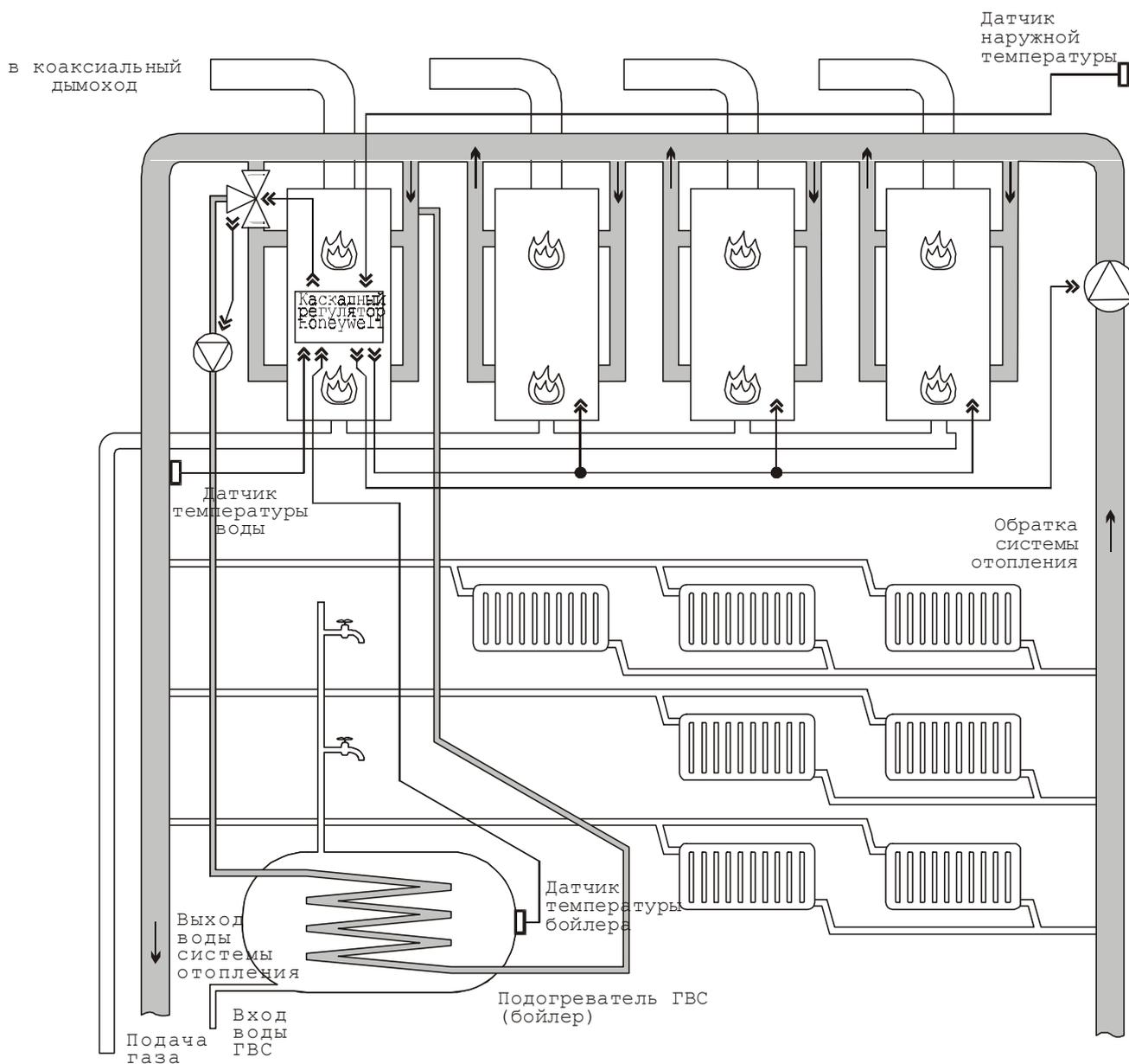
Рисунок 1- Схема системы теплоснабжения с котловыми модулями ПРОТЕРМ 50
