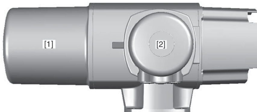
рис. 54: Доступ к предохранителям
