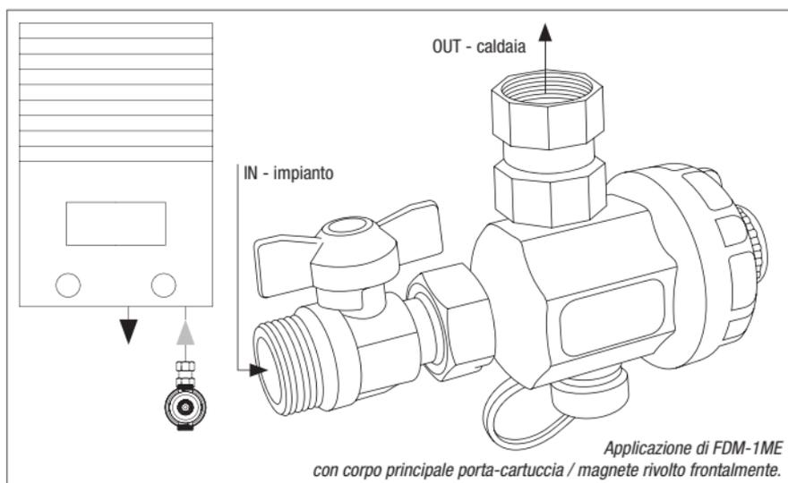
**ATTENZIONE:** prima di eseguire qualsiasi operazione di installazione o manutenzione, assicurarsi che l'impianto di riscaldamento sia isolato. E' consigliato installare FDM-1ME sul circuito di ritorno, in ingresso della caldaia, per proteggerla da tutte le impurità presenti nell'impianto, soprattutto nella fase di avviamento. (Schema A)
