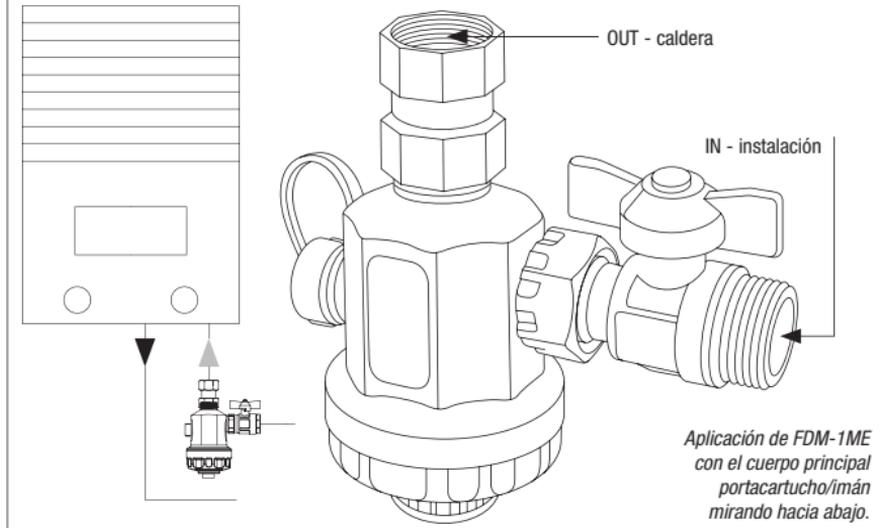
**ATENCIÓN:** para evitar daños debidos al congelamiento, evite instalarlo en lugares donde las temperaturas pueden descender por debajo de 0 °C.
