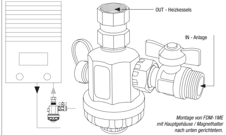
**ACHTUNG:** Um Frostschäden zu vermeiden, den Filter nicht an Stellen montieren, an denen die Temperatur unter 0 °C sinken kann.
