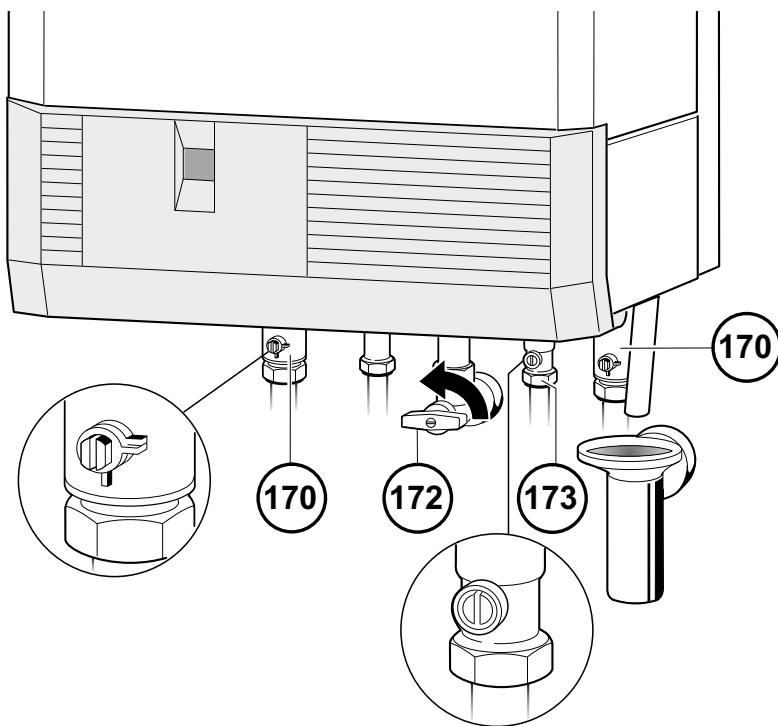
**Контроль давления воды в системе отопления**
