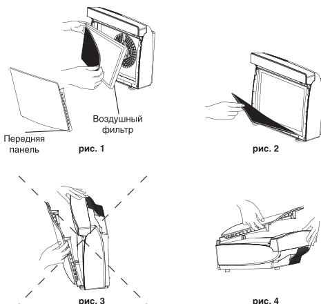
Перед первым включением прибора, руководствуясь указанными ниже действиями, удалите защитную оболочку с воздушного VOC-фильтра:
