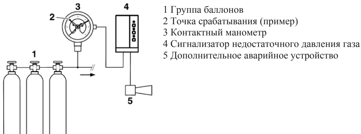
Рис. 3: Контроль над состоянием давления в группе баллонов
