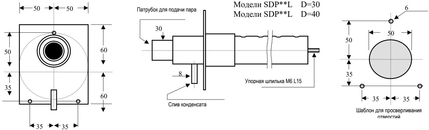
Линейные распределители монтируются следующим образом (см. Рис. 4.3):
