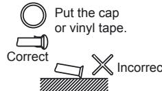
No coloque la tubería directamente en el suelo.
