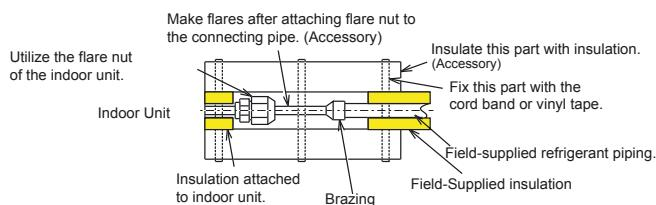
1. Χρησιμοποιήστε καθαρούς χάλκινους σωλήνες χωρίς υγρασία και ξένα υλικά στην εσωτερική επιφάνεια των σωλήνων. Όταν συνδέετε τον σωλήνα ψυκτικού, κόψτε χάλκινους σωλήνες με ειδικό κόφτη σωλήνων και φυσήστε τους με άζωτο, ώστε να μη μείνει καθόλου σκόνη στον σωλήνα. Μην χρησιμοποιήσετε πριόνι και πέτρα ακονίσματος και άλλα αντικείμενα που προκαλούν μεγάλη ποσότητα σκόνης.
