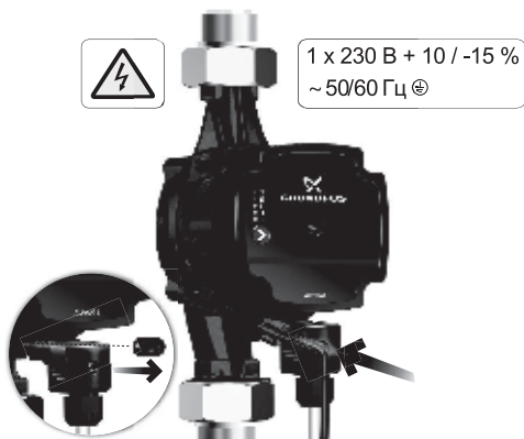
Рис. 9 Подключение сигнального кабеля к ALPHA1
