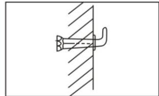
в) Подвесьте водонагреватель за кронштейн корпуса на крюки анкерных болтов. Убедитесь в том, что нагреватель надежно закреплен.
