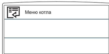
Нажмите кнопку "OK" для входа в подменю параметра. поверните рукоятку для выбора необходимого раздела меню. Поверните рукоятку для выбора значения изменяемого параметра. Нажмите "OK" для сохранения. Нажмите кнопку "ESC" для возврата к основному виду дисплея. Можно получить доступ к различным параметрам, для изменения используйте кнопки ОК и поворотную рукоятку (см. рис. ниже).
