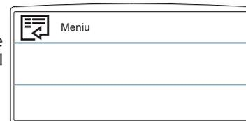
Apasati butonul ok pentru a accesa meniul si sub meniul. Rotiti butonul encoder pentru a schimba setarile parametrilor. Apasati butonul OK pentru a salva noile setari. Apasati butonul ESC pentru iesire, pana cand ecranul normal al displayului este restabilit.
