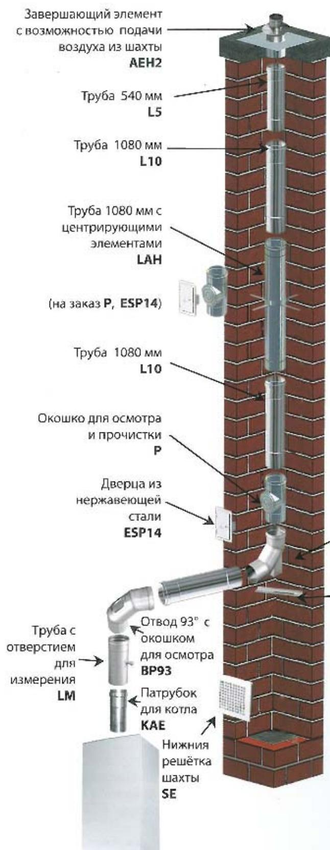
**5.) Дымоход с подсосом воздуха для горения топлива - низкое давление - установка LAS**
