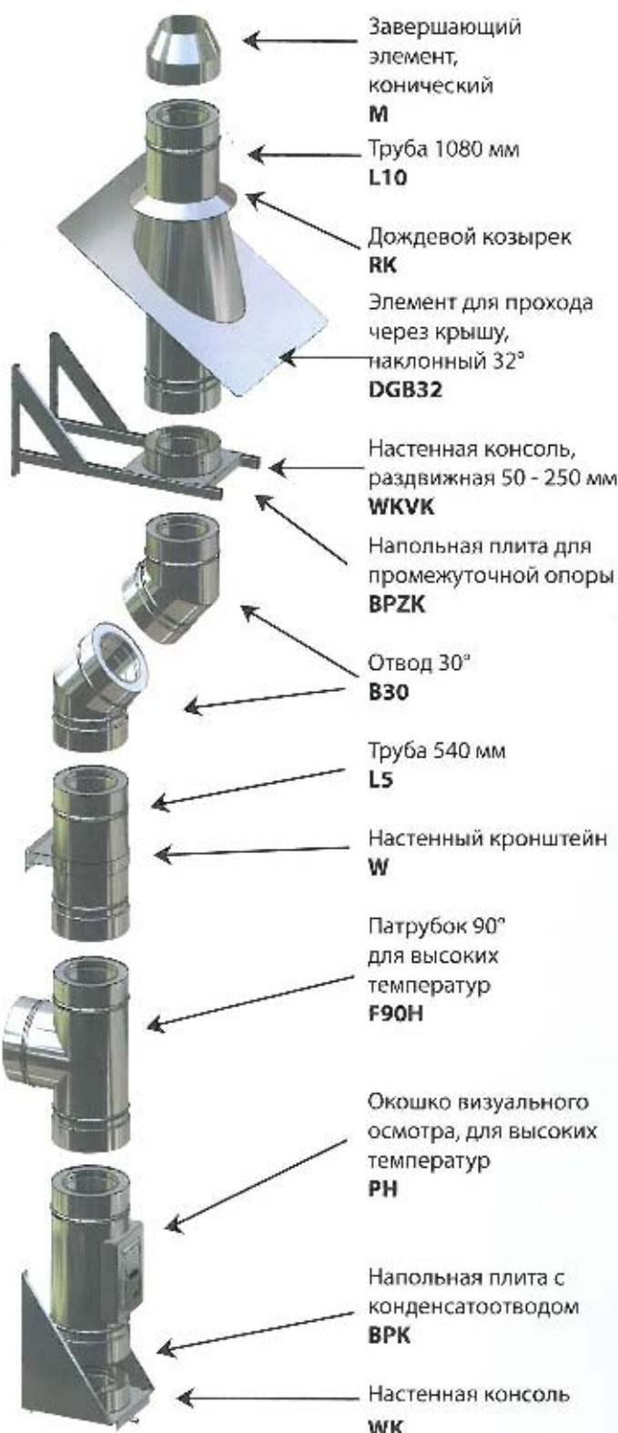
**3.) Дымоход на жидком и газообразном топливе- высокое давление (с надувными горелками)**
